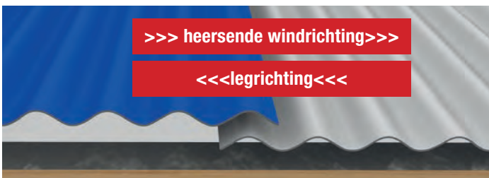
Doorsnee: voorbereiden van acrylaat lichtplaten
