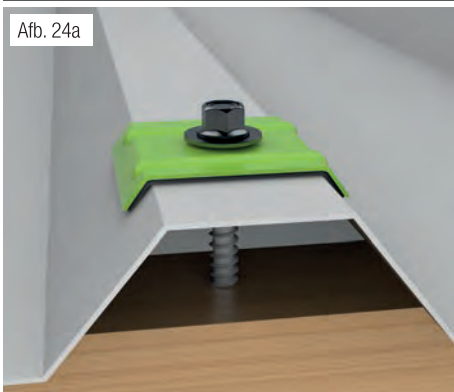
bevestigingsschroef met E16 dichtring met kalotte op profielberg / golftop
